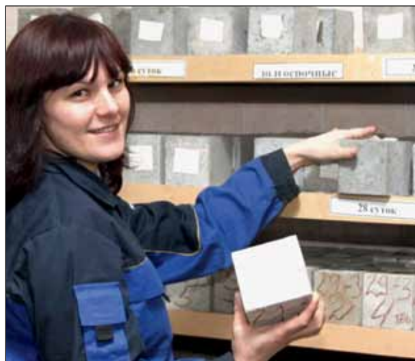
Образцы бетонов, полученные с применением различных добавок, проходят строгие испытания по набору прочности через разные периоды времени
